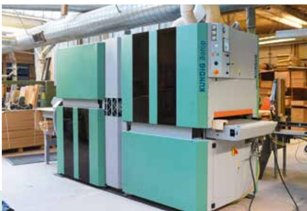
Die Bestückung mit drei Körnungen erlaubt es, in einem Durchgang von der gehobelten zur fertigen Oberfläche zu kommen.
