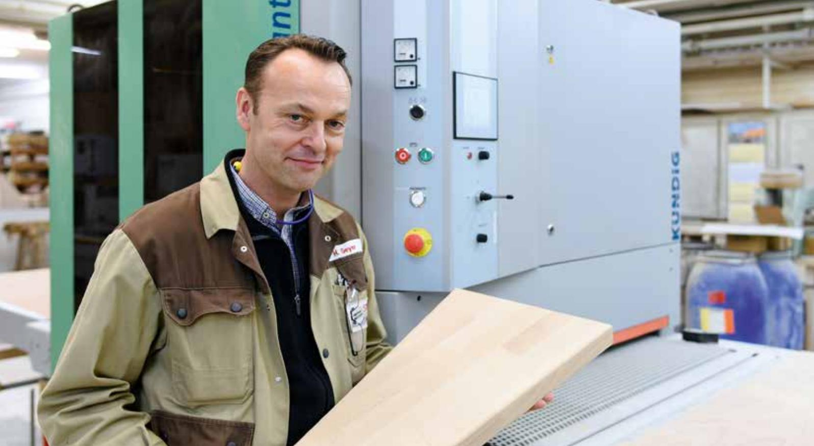
Heiko Geyer mit „seiner“ Kündig Brilliant-2 1100 RPD: „Treppenteile sind selten gerade Bretter. Wir können mit dem Diagonalschliff auch schräg oder quer zur Faser schleifen und die Flächen werden dennoch sehr glatt.“
