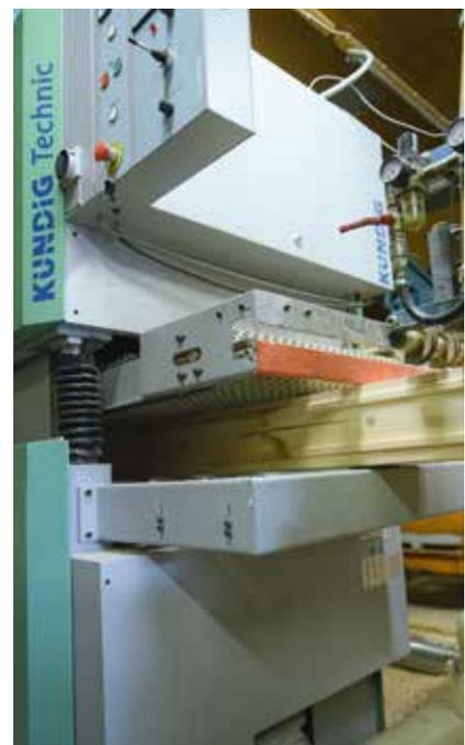
*Die unten schleifenden Aggregate der Kündig Technic Botex-2 könnten mit bis zu einer halben Tonne belastet werden.*
