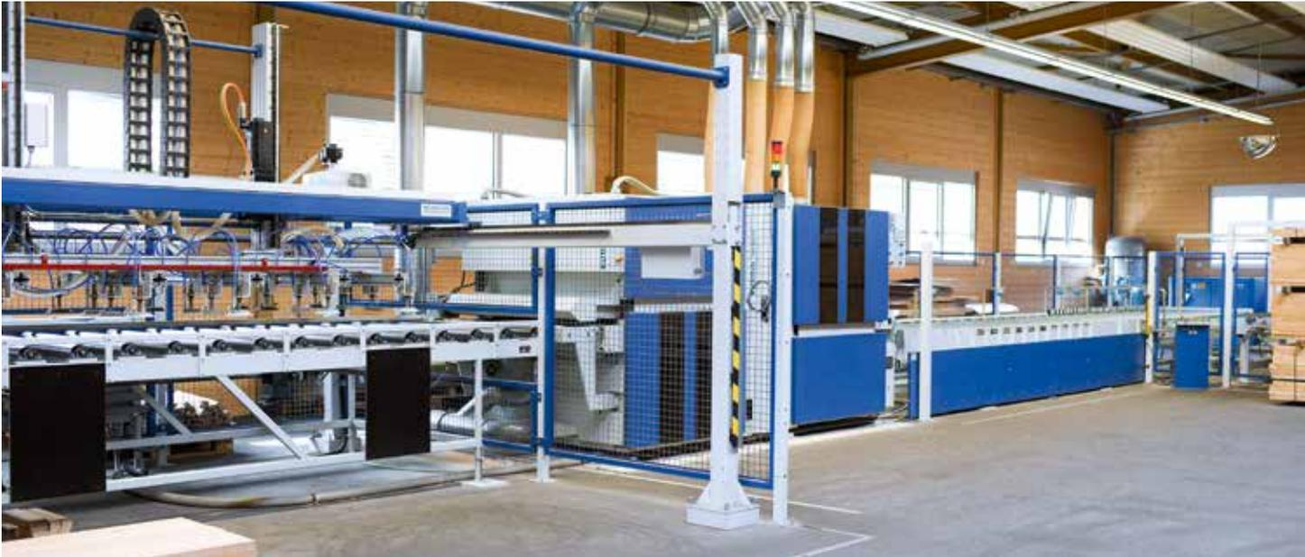
*Ausnahmsweise nicht grün: Die Kündig Technic Botop-6 1350-RRP-RRP bei Laubholz-Plattenhersteller Ohnemus wurde für ein einheitliches Erscheinungsbild blau lackiert. Auch technisch ist die Hochleistungs-Schleifanlage nahtlos in die Produktionslinie integriert.*
