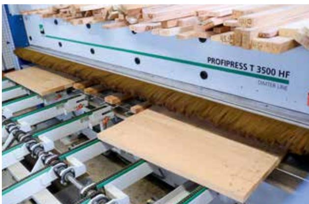
*Die Platten werden, so wie sie aus der Presse kommen, bis zu einer fertigen Oberfläche geschliffen.*
