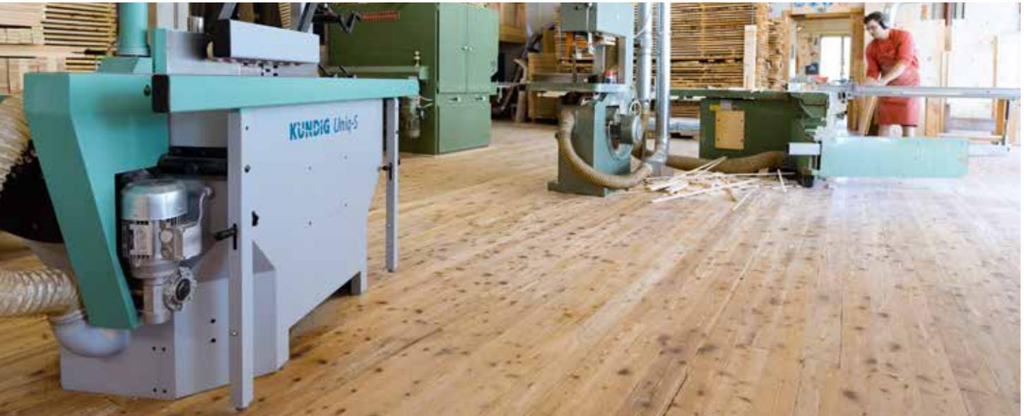
*Vor allem die praxisgerechten Detaillösungen der Uniq-S, wie Vorschub, beidseitige Verwendbarkeit oder der mit oszillierende Schleifgel unter der zylindrischen Abdeckung links im Bild, haben es allen in der Tischlerei Kratzer angetan.*
